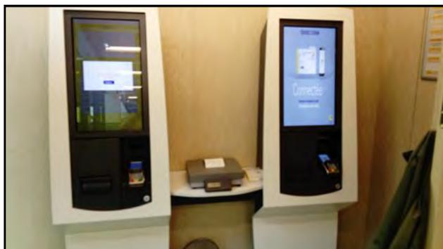
Le CALISE se présente sous la forme de deux colonnes, contenant chacune un libre-service affranchissement, séparées en leur centre par une console sur laquelle est posée une balance commune connectée.
